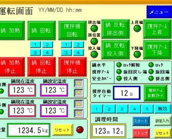
操作画面はタッチパネルで、とても操作し易くなっています。また、速度選択・温度選択・調理時間設定も簡単に行え、計量機能付で重量の確認も出来ます。
